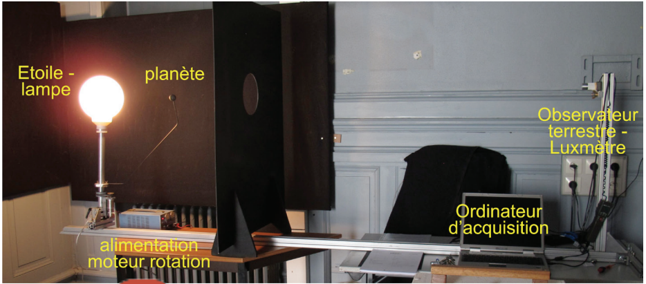
Montage de la méthode des transits
