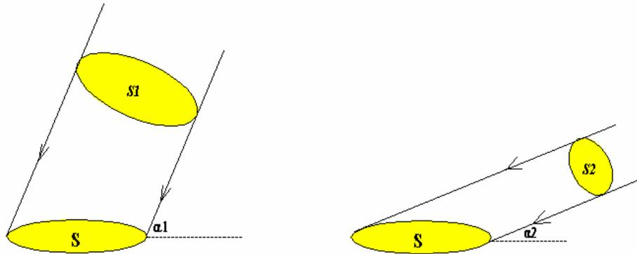
Un faisceau cylindrique de rayons solaires intercepte sur le sol une surface qui a la forme d'une ellipse.
